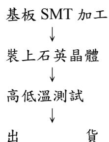
依設計之補償電路，以 SMT 方式，著裝上必要之零組件後，接上石英晶體，再依客戶規格作高低溫測試，每顆振盪器均有完整之測試報告。
